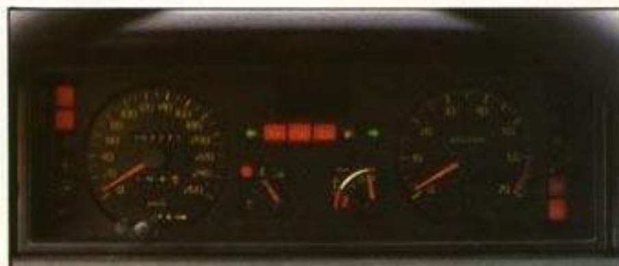
La instrumentación analógica es clara y legible. El indicador del aceite es bifunción: nivel y manómetro.
