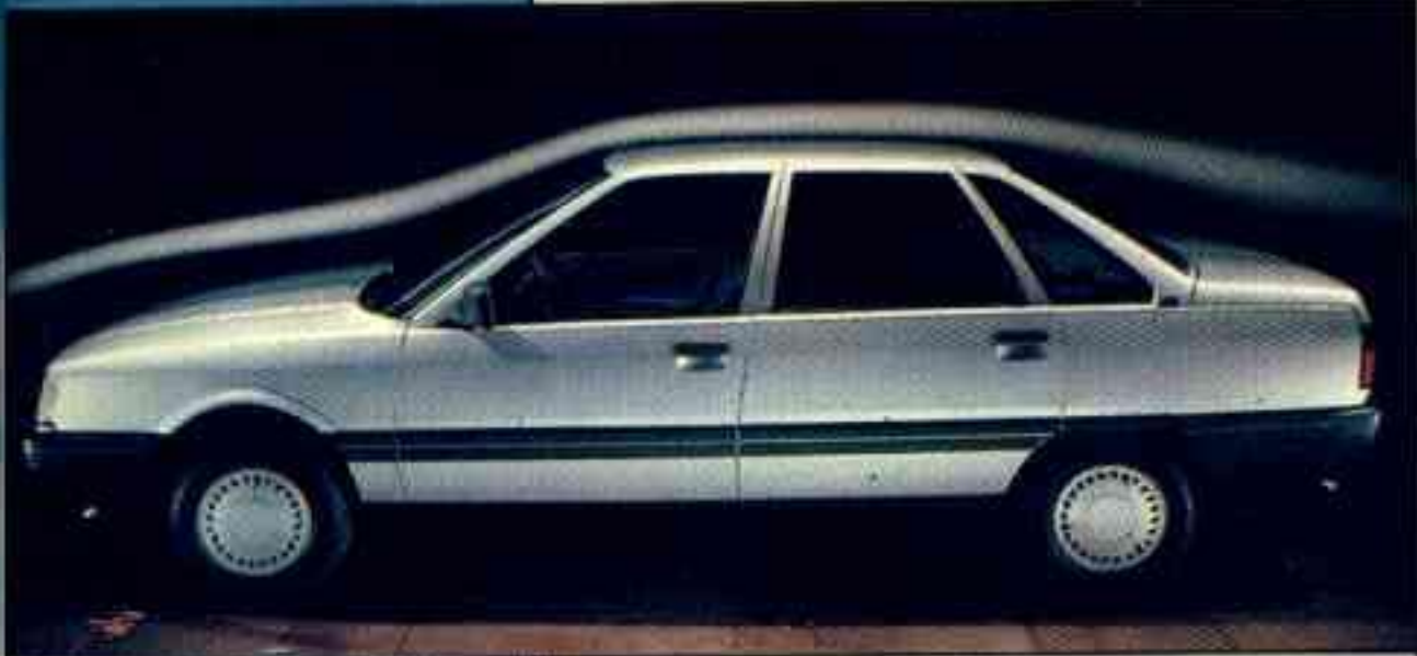
Buena penetración aerodinámica. Un CX aceptable, sin llegar a ser excepcional.
