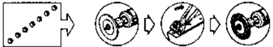
A fin de facilitar la extracción del panel tras el corte, utilizar un sopleta de aire caliente para despegar el panel del cajón.
