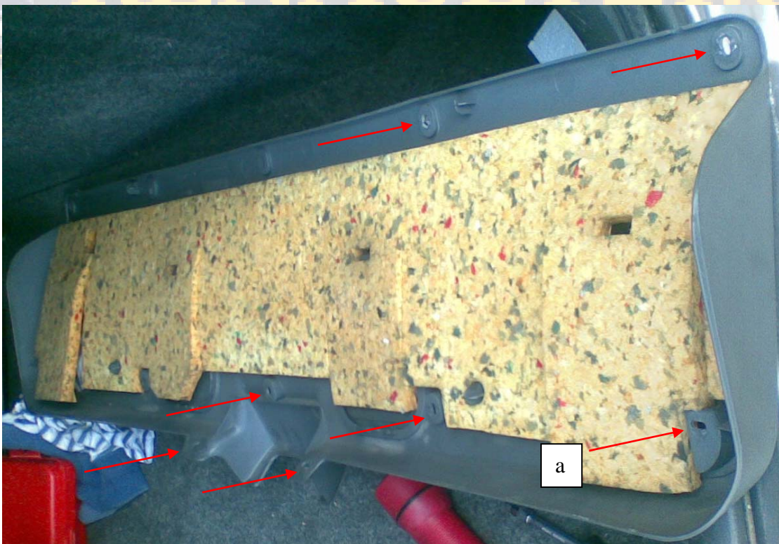
Fig. 2. Guarnecido. Detalle de algunos de los alojamientos para tornillos de sujeción. a) Alojamiento del tornillo tras la puertecita derecha.
