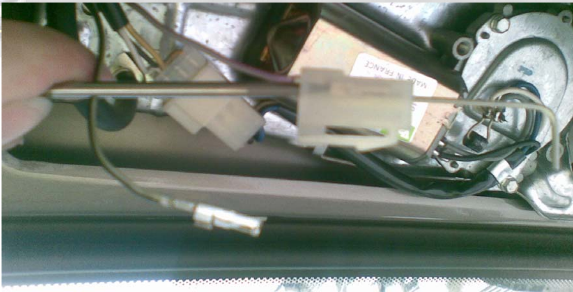
Fig. 7. Desmontaje de los terminales del conector.
