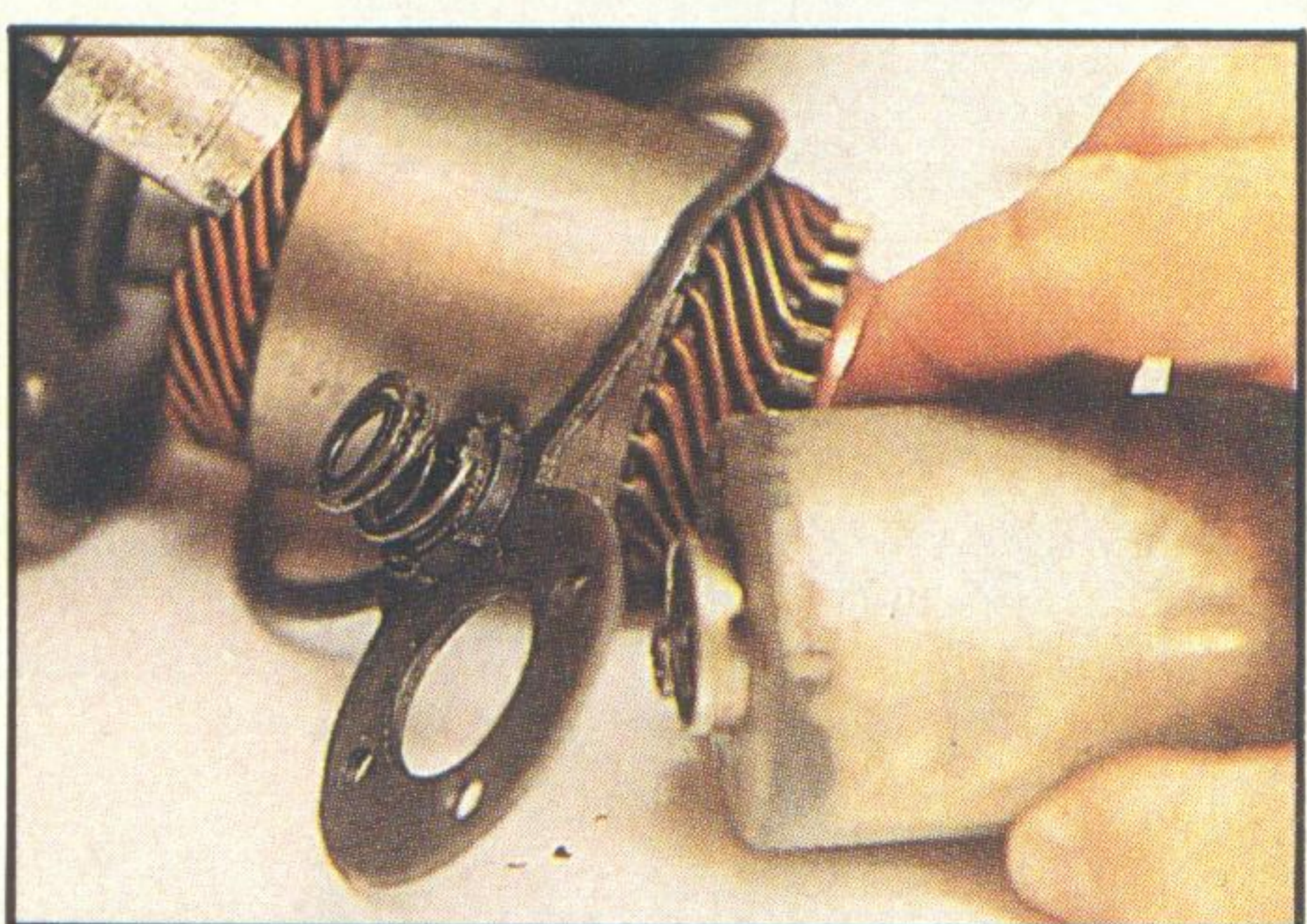
13 No perder nada. Uno de los muelles normalmente empuja la palanca de la horquilla y el otro va en el interior del relé. Procurar recordar su posición para el posterior montaje.
